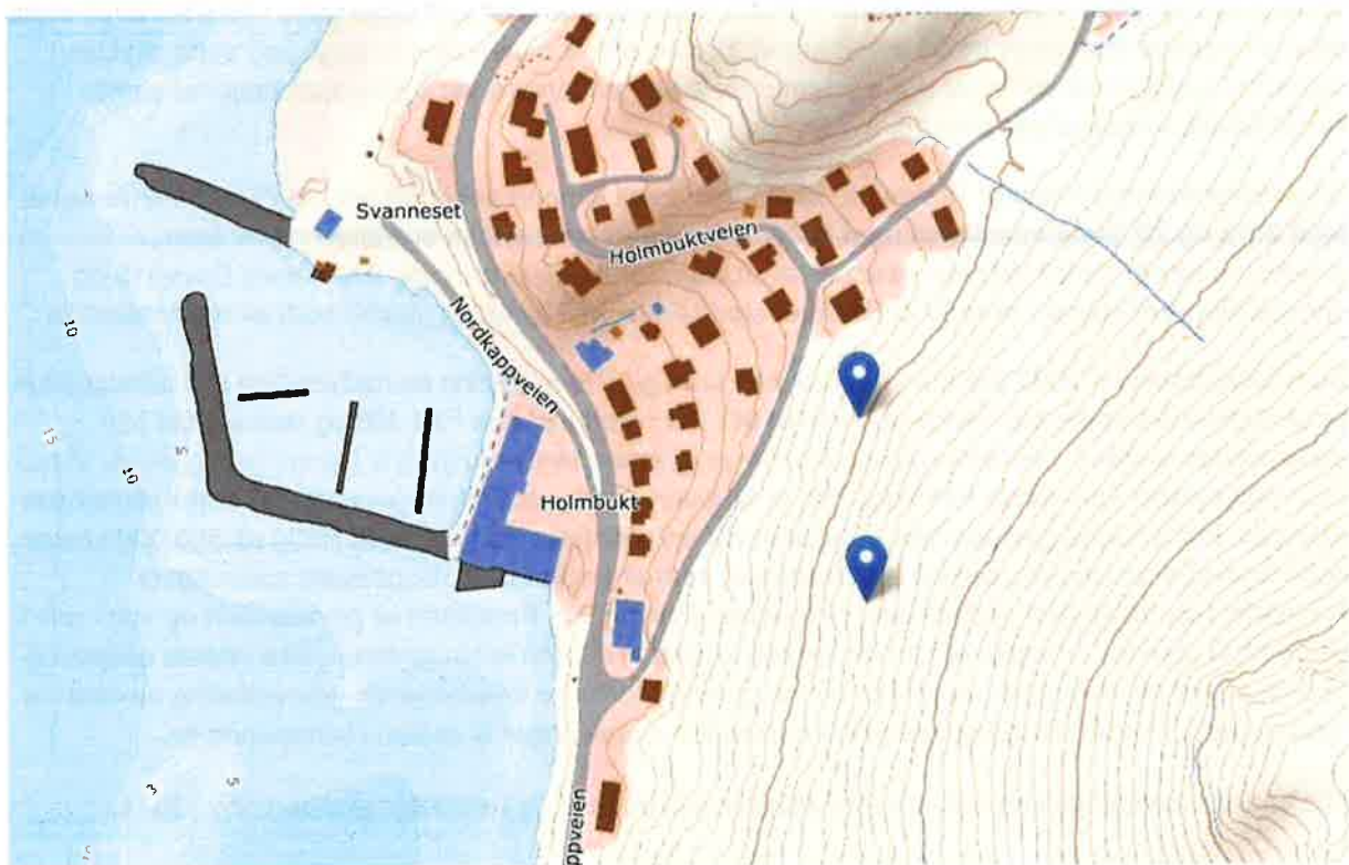
Figur 1 To master med snø sensorer er satt ut i fjellsiden. Disse overvåker snødybden for hver sin skredbane
